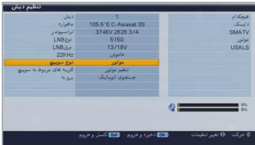
اگر از دیش جک دار از نوع 1.2 استفاده میکنید در قسمت نوع سوییچر Motor را انتخاب نمایید.
