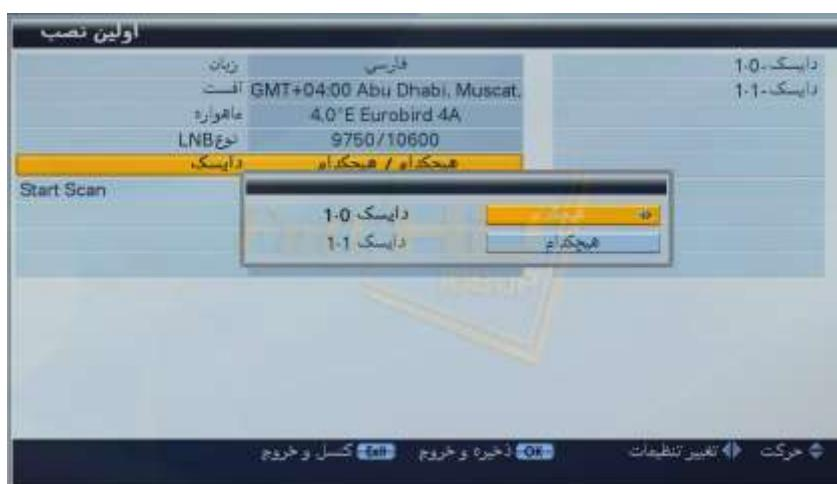
اگر از سوییچر DiSEqC 1.0 و یا استفاده مینمایید، گزینه DiSEqC 1.1 را با استفاده از دکمه های ▲ / ▼ انتخاب نمایید.
