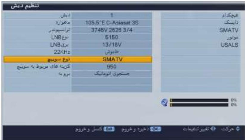
در صورتیکه از سوییچر استفاده میکنید در قسمت نوع سوییچر SMATV را انتخاب کنید. در قسمت option عددی بین (950~2150) را وارد کنید.
