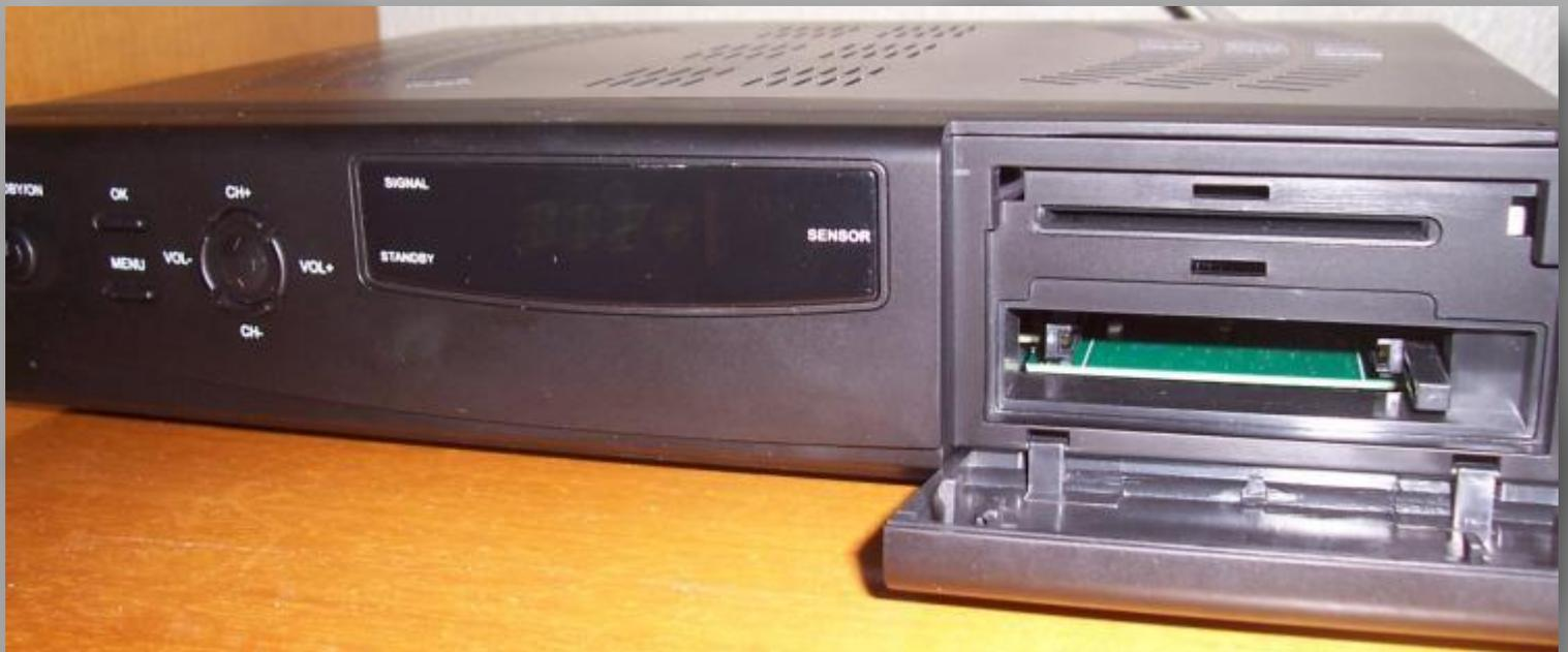
Además cuenta con dos LEDs; uno rojo y otro verde. El rojo nos indica el estado del receptor (encendido o apagado) y el verde nos dice si estamos recibiendo señal o no.
