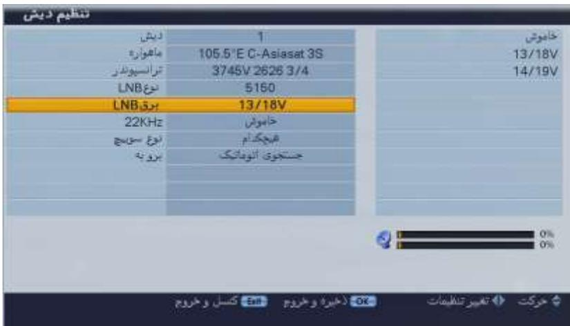
میزان ولتاژ مصرفی LNB را با استفاده از دکمه **◀ / ▶** تعیین نمایید. شما میتوانید میزان ولتاژ را با توجه به میزان معمول همان 13/18V تعیین نمایید. در صورتیکه فاصله شما با دیش بیش از ۶۰ متر میباشد میبایست گزینه 14/19V انتخاب شود. وقتی از سیستم کابلی UNICABLE استفاده میکنید این ولتاژ باید خاموش باشد.
