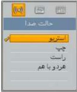
با استفاده از دکمه های **▲ / ▼** میتوانید حالت تولید صدایی خروجی دستگاه را عوض کنید (چپ، راست، هر دو با هم، استریو) برای ذخیره کردن تنظیمات و خروج دکمه OK را بزنید.
