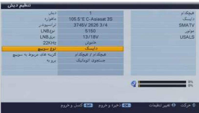
گزینه Switch Type را در صورت استفاده از سویچر انتخاب کنید. در صورتیکه از سویچر DiSEqC 1.0 و DiSEqC 1.1 استفاده میکنید در قسمت نوع سویچر گزینه DiSEqC را انتخاب کنید. ورودیهای سویچر در گزینه option قابل تنظیم میباشد.
